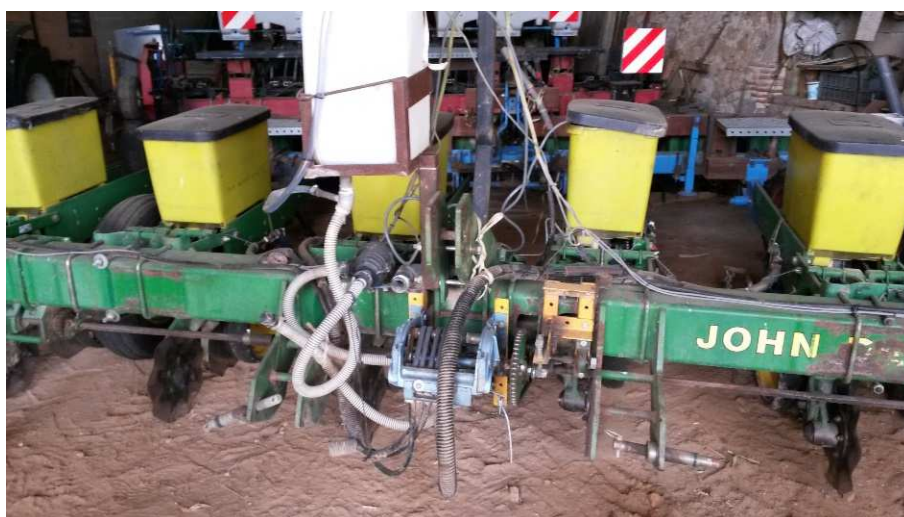
Semoir monograin équipé du kit Precision Planting
